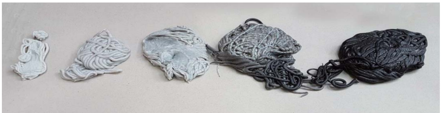
最右部分：PA66材料 中間部分：清洗後第一次射出的DREYCHEM 最左部分：清洗完畢後的帶出的材料
