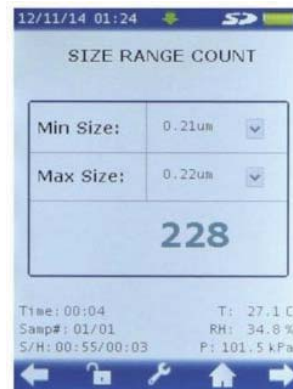
高级功能可设定特殊颗粒尺寸的范围进行精确测量，解析度高达10µm
