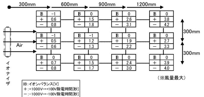
(注1): □ 150mm、20pFのチャージドプレートモニターを使用して測定。
